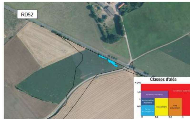
Projet en zone inondable au droit du raccordement avec la RD52 (selon le PPRI)
