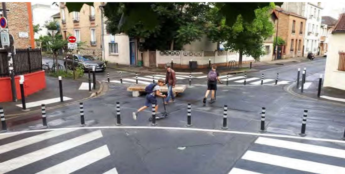
Le filtre modal permet de supprimer efficacement le trafic de transit (CEREMA).
