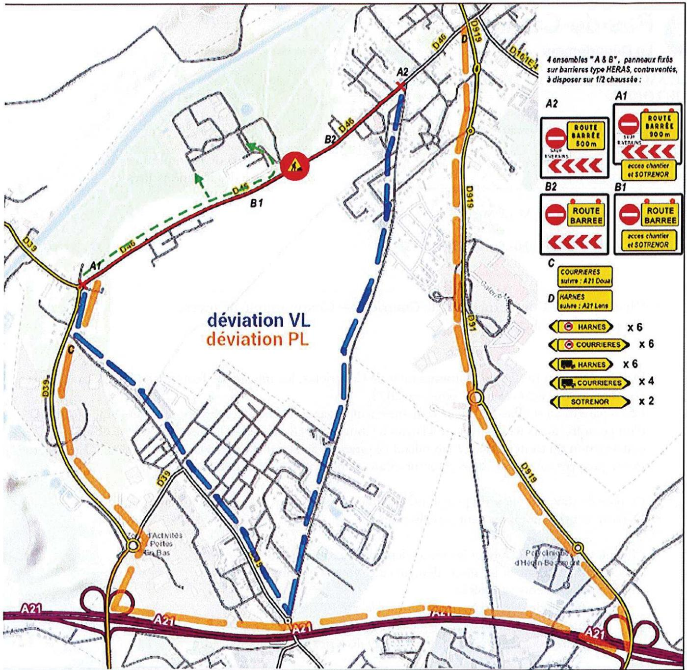
4 ensembles "A & B", panneaux fixés sur barrières type HERAS, contreventés, à disposer sur 1/2 chaussée :
